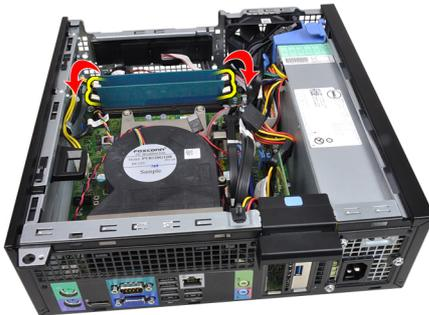
6. Angkat modul memori dari konektor pada board sistem.
