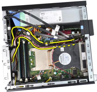
6. Lepaskan sambungan panel I/O atau kabel FlyWire dari board sistem.
