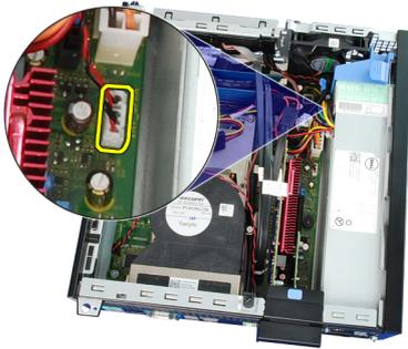
6. Lepaskan kabel speaker internal dari klip pelindung kipas.
