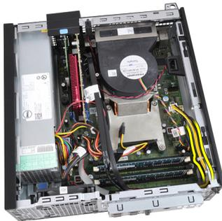
8. Lepaskan kabel daya 24-pin dari board sistem.
