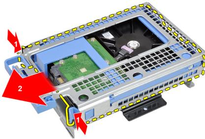
5. Longgarkan braket hard disk dan kemudian lepaskan satu hard disk 3,5 inci atau dua hard disk 2,5 inci dari braket.
