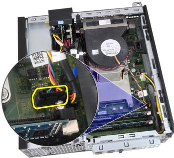
6. Lepaskan Board Input/Output atau kabel FlyWire dari saluran perutean pada unit pendingin.
